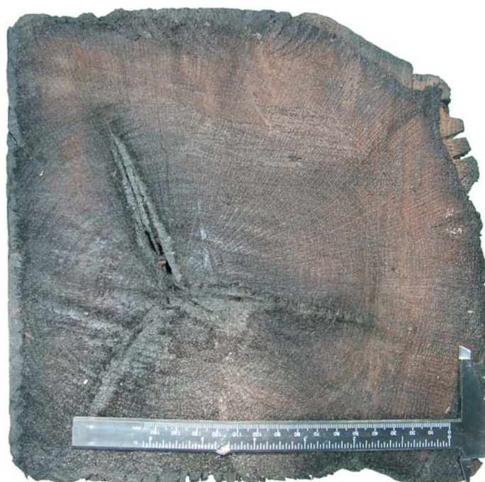
Afbeelding 13.2: dwarsdoorsnede van een aangepunte eikenhouten paal (vondstnummer 173), geschikt voor een dendrochronologische datering. Foto: S. Lange.
